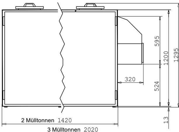
Maßzeichnung Nassmüllkühler für 120 Liter Mülltonnen mit Seitenkühlgerät STFSEIT (Einbaumaß)
